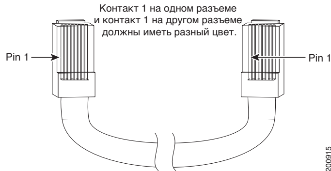
Рисунке В-10 Как определить перекрестный кабель
