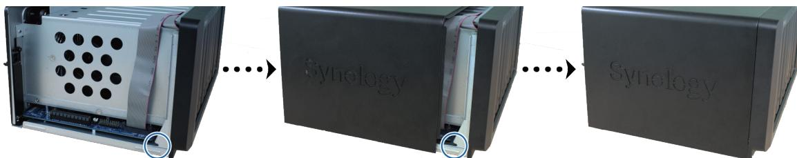
**4** Установите верхнюю крышку, снятую на шаге 2, совместив ее с обведенным контуром, и закрепите винты.
