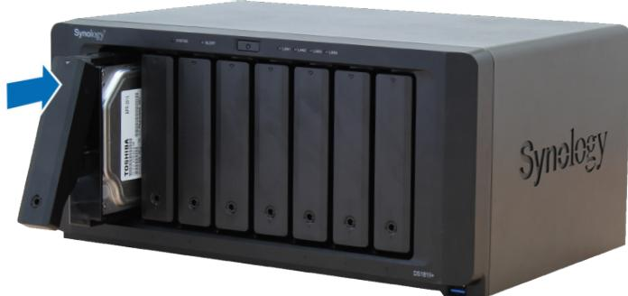
**Примечание.** Убедитесь, что лоток задвинут до упора. В противном случае в работе диска могут возникнуть неполадки.
