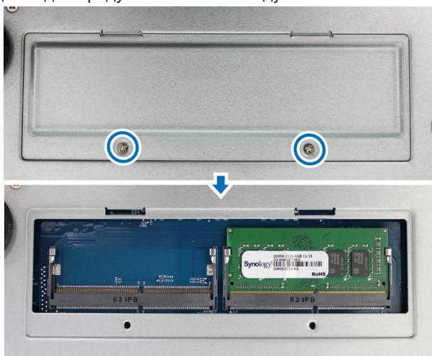
**Внимание!** При снятии панели вы подвергаете чувствительные внутренние компоненты внешнему воздействию. Не трогайте внутренние компоненты за исключением блока памяти, который вы собираетесь извлечь или добавить.
