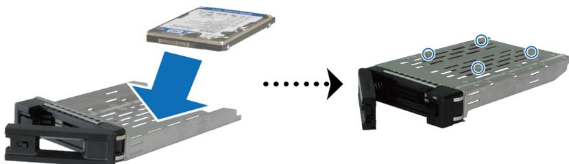
3 Вставьте лоток с установленным диском в пустой отсек для жестких дисков.
