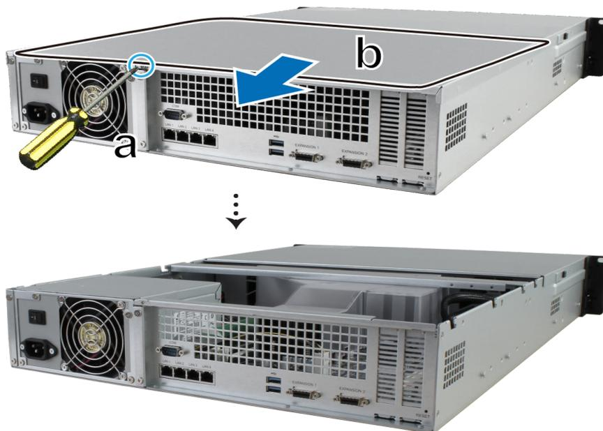
**a** Отвинтите винт на задней стороне RackStation.
