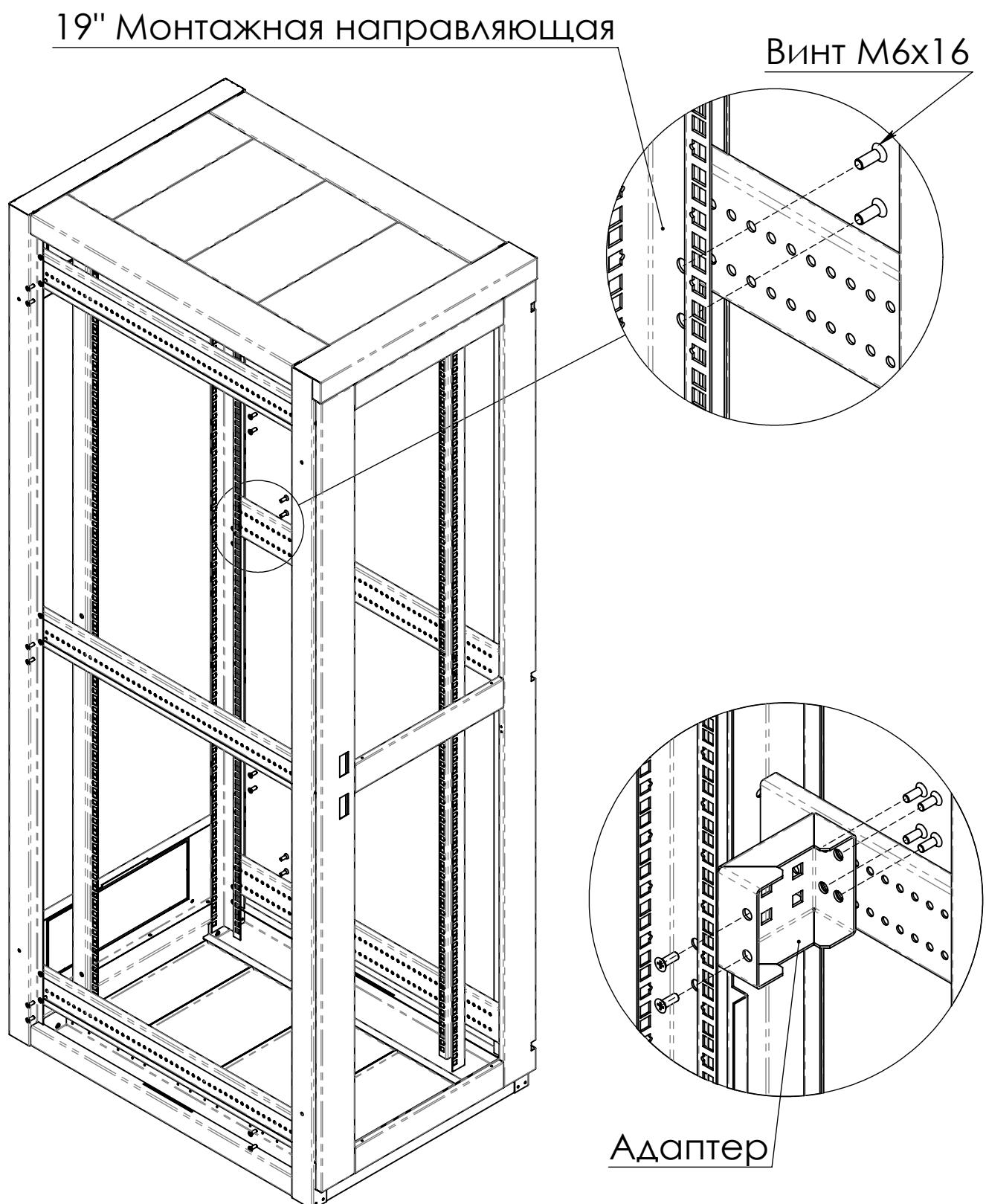
В шкафах шириной 800 мм для установки 19" Монтажных направляющих используются АдAPTERы, которые устанавливаются как показано на рисунке.
