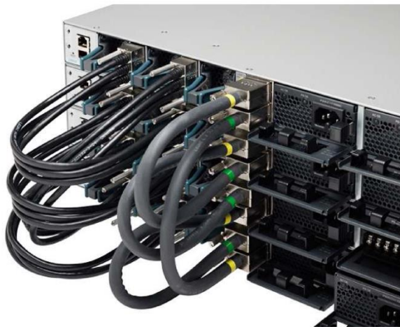
Рисунок 5. Разъемы StackWise-480 и StackPower
