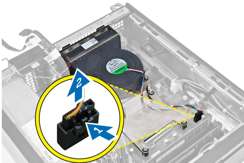
6. Ослабьте невыпадающие винты, приподнимите радиатор в сборе и выньте из компьютера. Положите его таким образом, чтобы вентилятор был обращен вниз, а термопаста была обращена вверх.
