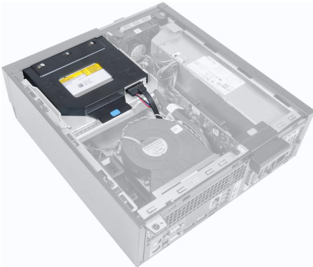
3. Отсоедините кабель передачи данных и кабель питания от задней части оптического дисковода.
