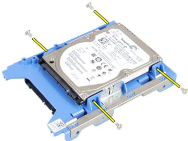
6. Выверните винты, которыми жесткий диск крепится к нижней части скобы жесткого диска.
