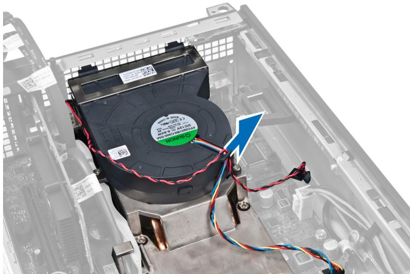
5. Нажмите на зажим, чтобы высвободить кабель вентилятора и отсоединить его от системной платы.
