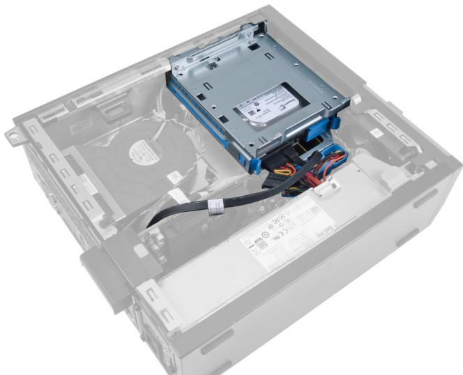
3. Отсоедините кабель передачи данных и кабель питания от задней части диска.
