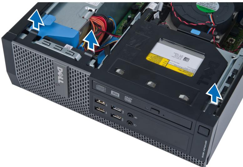
4. Поворачивая лицевую панель, отведите ее от компьютера, чтобы высвободить ее из зацепов на обратной стороне панели. Затем поднимите корпус и снимите лицевую панель с компьютера.
