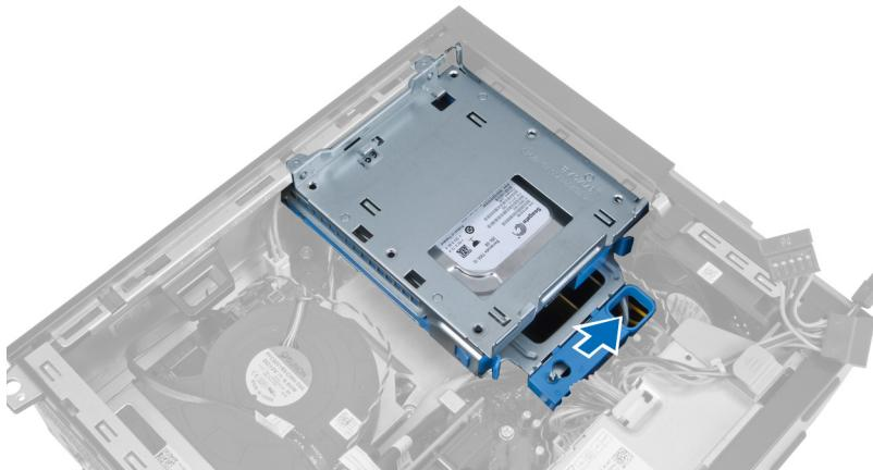
5. Поверните отсек для дисков вверх, взявшись за ручку и извлеките его из корпуса компьютера.
