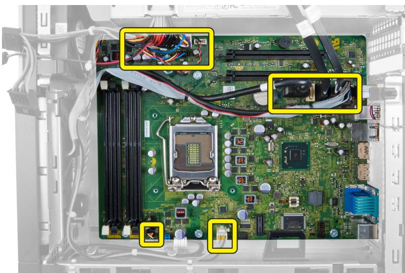
4. Выверните винты, которыми системная плата крепится к корпусу.
