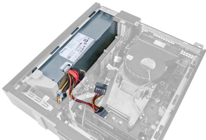
3. Отсоедините 4-контактный кабель питания от системной платы и высвободите его из зажимов на корпусе.
