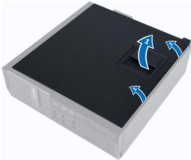
3. Приподнимите крышку вверх под углом в 45 градусов и снимите с компьютера.
