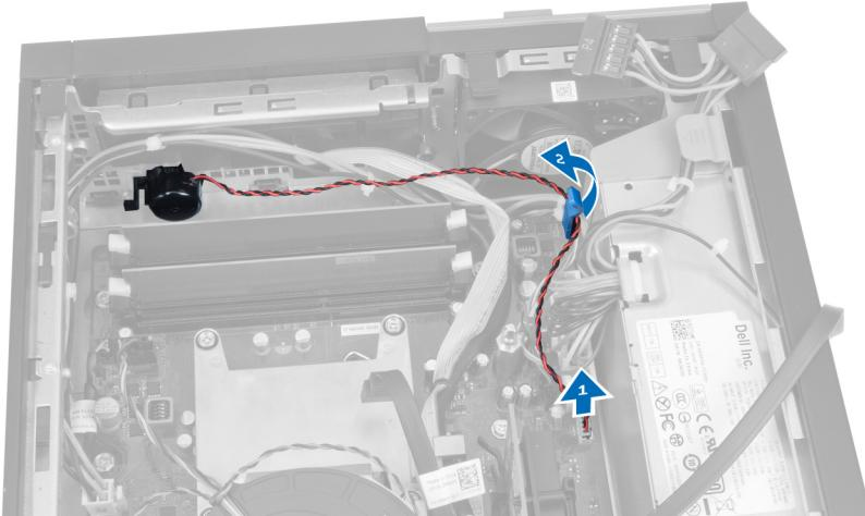
4. Нажмите на фиксатор динамика и сдвиньте динамик в сторону правой части компьютера, чтобы высвободить его.
