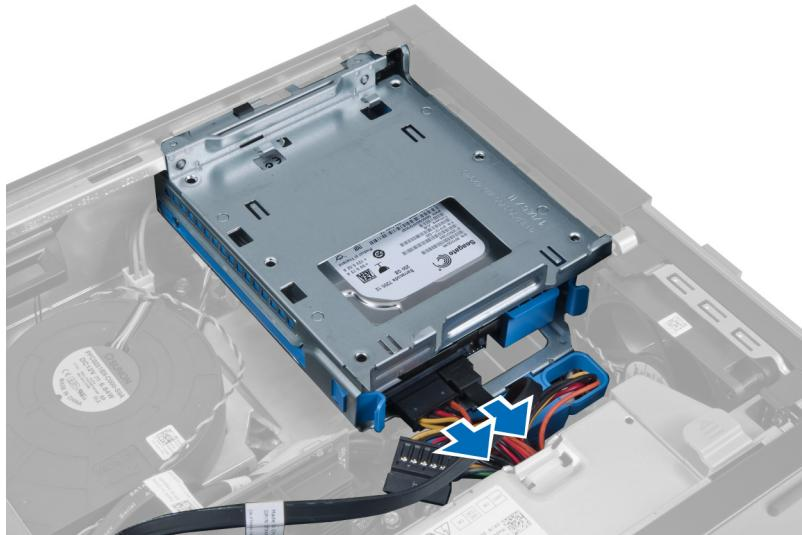
4. Сдвиньте ручку отсека для дисков в сторону задней части компьютера, чтобы разблокировать его.
