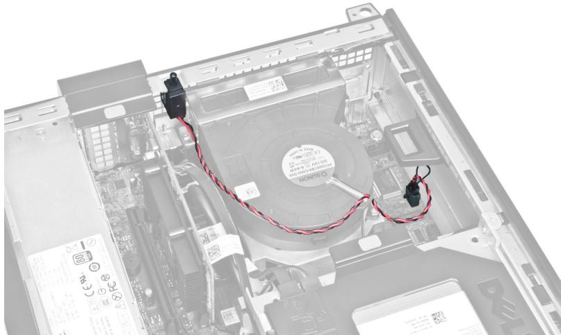
3. Отсоедините кабель датчика вскрытия корпуса от системной платы.
