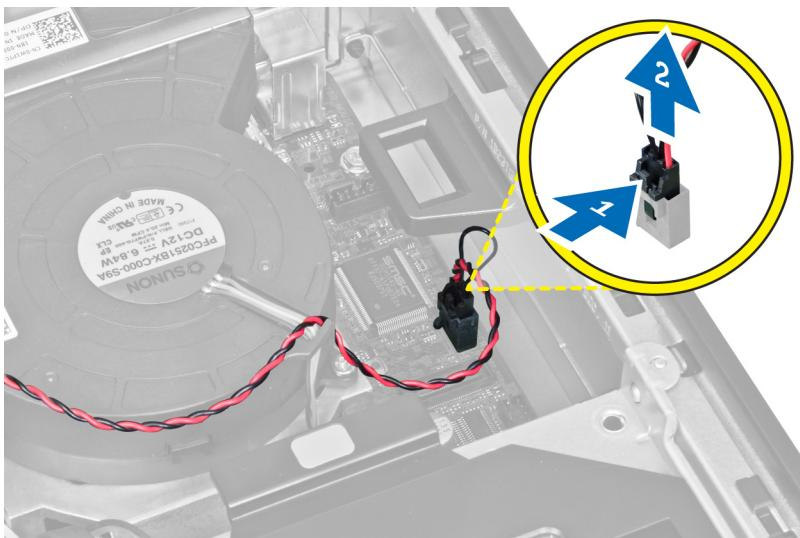
4. Сдвиньте датчик вскрытия корпуса внутрь и снимите его с системной платы.
