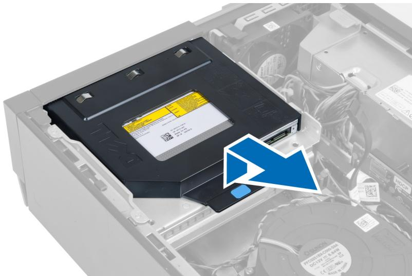
5. Отогните края скобы, чтобы извлечь оптический дисковод.
