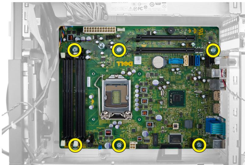
5. Поверните винт с шестигранной головкой против часовой стрелки и извлеките его из системной платы.
