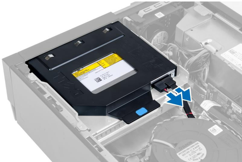
4. Поднимите синий фиксатор и сдвиньте оптический дисковод внутрь, чтобы извлечь его из компьютера.
