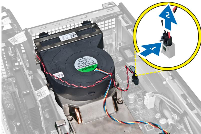
4. Высвободите кабель платы ввода-вывода/микропровод FlyWire из направляющей на радиаторе.
