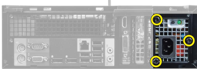
8. Нажмите на синий фиксатор рядом с блоком питания и сдвиньте блок питания в сторону передней части компьютера.
