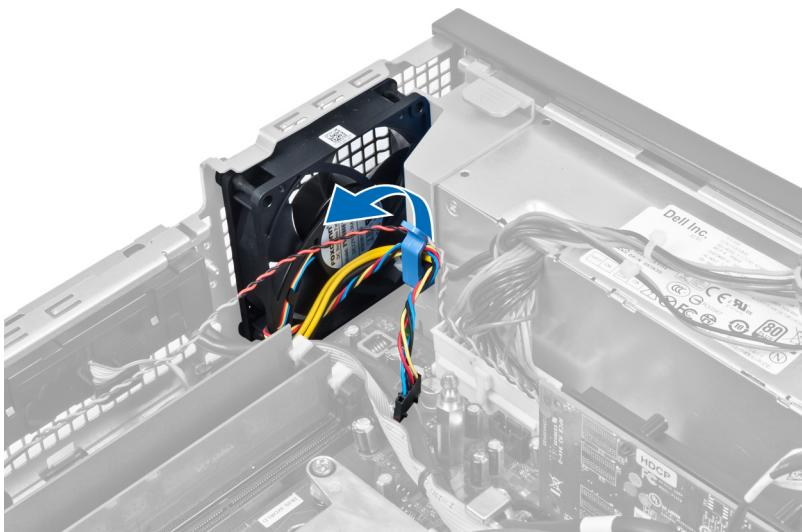
5. Подденьте системный вентилятор и снимите его с изолирующих втулок, которыми он крепится к компьютеру. Затем втолкните втулки внутрь вдоль канавок и протолкните через корпус.
